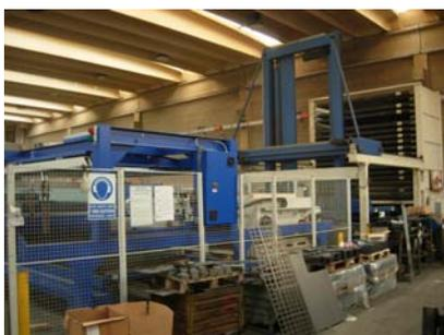
**Flessibilità ed efficienza** di rendimento sono le prerogative più importanti del nuovo centro di taglio laser **TRULASER 3530 (TRUMPF)** (completo di carico-scarico "Cargotech 3015 LSR" - Innovatech) installato a febbraio 2008.
