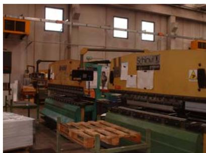
Utilizziamo, inoltre, n. 7 piegatrici a controllo numerico da 35 ton a 170 ton per una lunghezza fino a 3300 mm che ci permettono di piegare o deformare i vari pezzi a seconda delle esigenze del cliente:
